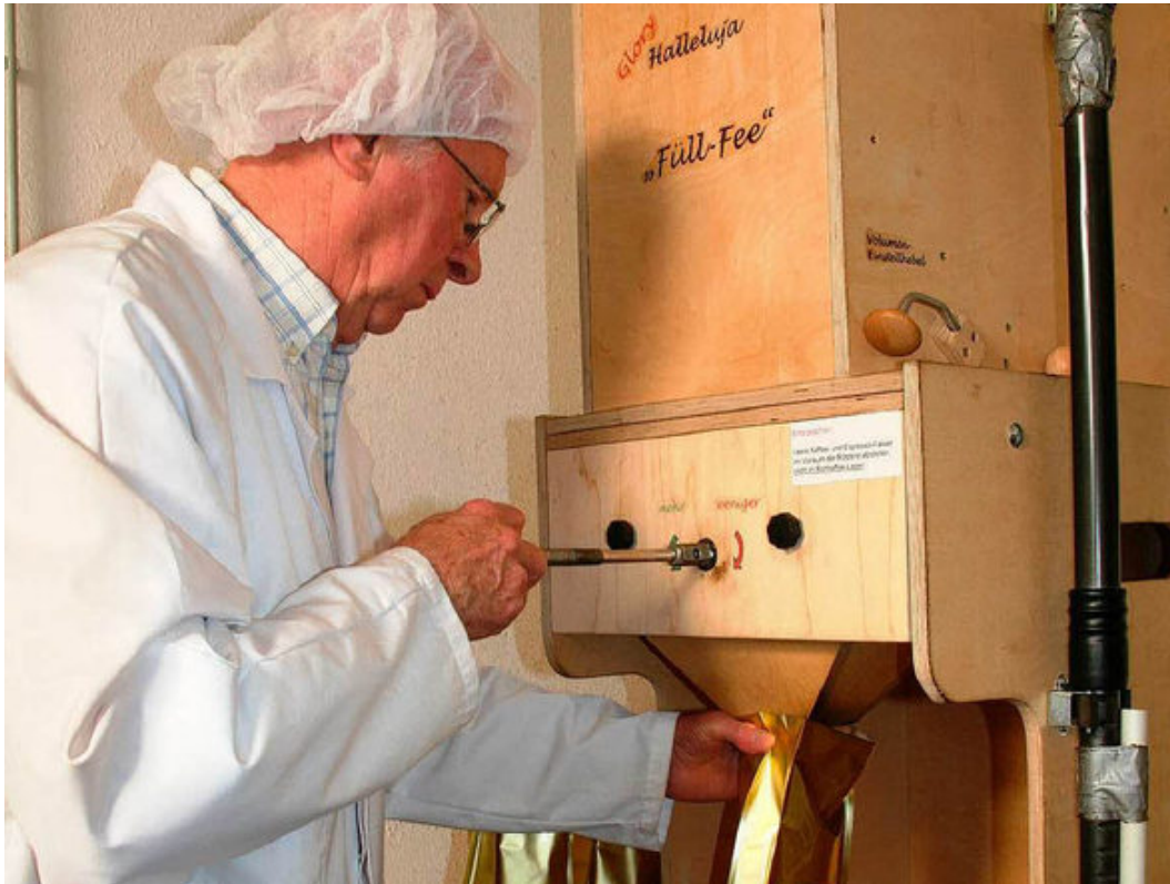
Maschine Marke Eigenbau: In Portionen von 250 Gramm lässt die Füllfee den Kaffee raus Foto: Marlies Jung-Knoblich
